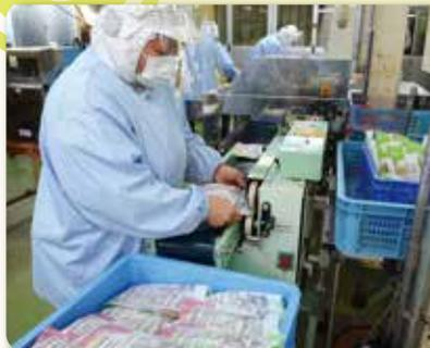
袋に詰めたものをシール加工し、さらに賞味期限の印字を行います。製品は機械にて重量確認、また2回目の金属探知検査を実施します。
