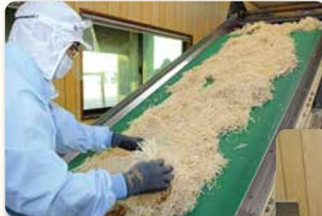
解凍した原料を専用機械を使ってほぐし、金属探知機にかけます。
