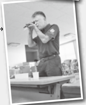
↑ 酸分析機を使ってクエン酸を測定 → 糖度計を使って糖度を測る様子
